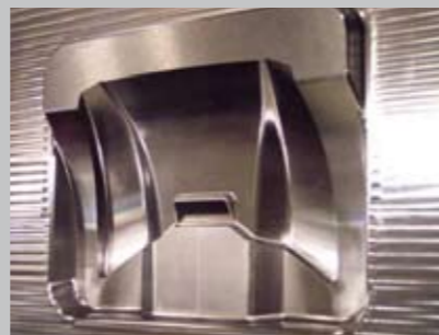
Uddeholm Nimax er et stærkt valg til f.eks. plastforme, når der er brug for et sejhærdet materiale med god hårdhed.
