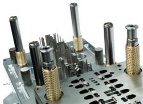
Følgesnitværktøj fra Stansomatic A/S i Uddeholm Sleipner og med indlæg og stempler i Uddeholm Vanadis 10
