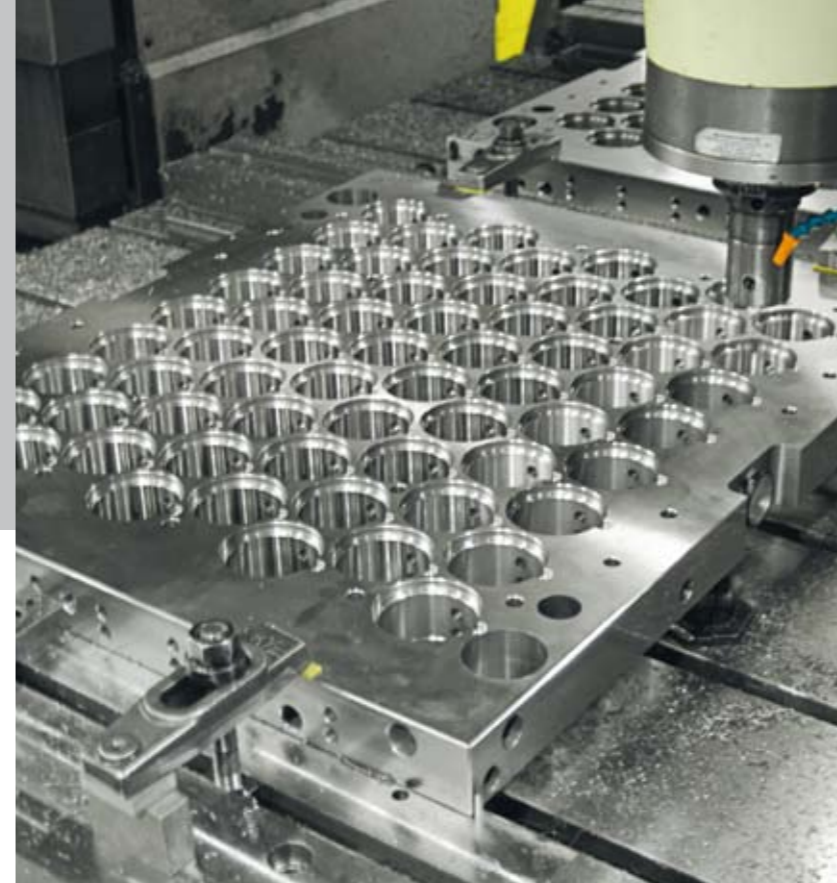
Bearbejdning af holderplader er ofte omfattende. Her giver Ramax LH's fine bearbejdelighed og prisniveau mulighed for store besparelser
