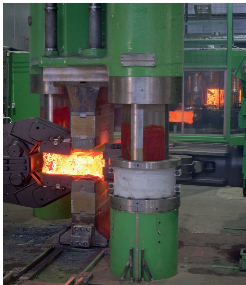
Uddeholms nye smedespresse i gang med test. Det glødende stykke stål spejler sig i ruden til centeret, hvor styring og kontrol af processerne foregår. Gennem rudens højre side skimtes en anden glødende stålblok, der er under smedning i smedespressen på den anden side af centeret.
