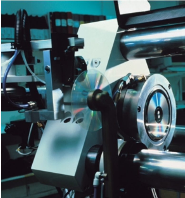
Polmax til CD-skiver. Kravene til renhed har fået endnu større betydning, efter at DVD og lignende produkter med mange data er kommet på markedet.
