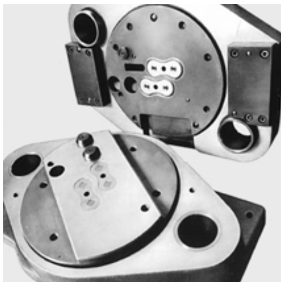
Et finklipningsværktøj i Sverker 3 til produktion af led der indgår i præcisionsfremstillede rullekæder.
