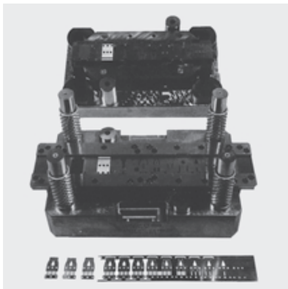
Flerstationsværktøj i Sverker 21 til produktion af lange serier af en kompliceret stanset og præget detalje.
