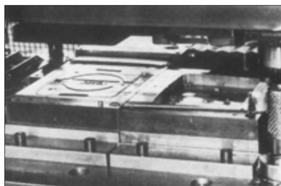
Værktøj i Rigor. 3.000.000 emner blev fremstillet inden værktøjet skulle slibes op.
