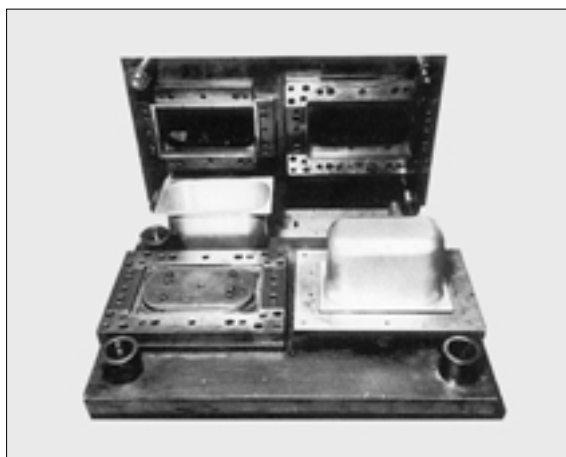
Afgrat- og kantformningsværktøj i Arne værktøjsstål til fremstilling af beholdere i 0,91 mm rustfri plade, i dimension 254 x 152 x 203 mm.
